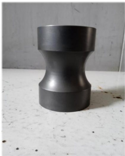
箱体外导轮镀纳米涂层 (降低铝粉量)
